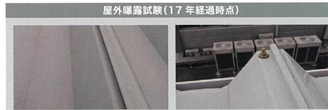
当社は日鉄鋼板(株)と連携し日本各地で長期にわたる屋外曝露実験・物件の追跡調査を実施しています。その調査から、基礎データを収集し、各塗装系・色相ごとに最適な塗膜仕様を設計しています。
